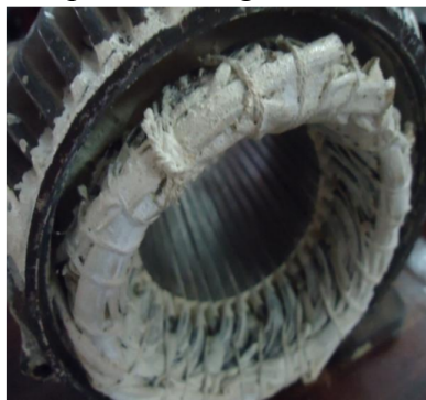
Hình 4.1. Cuộn dây động cơ có phủ lớp men với vật liệu nano
